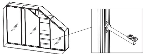
Dieser Beschlag wird entsprechend der Tiefe des Systems bauseits gekürzt.
