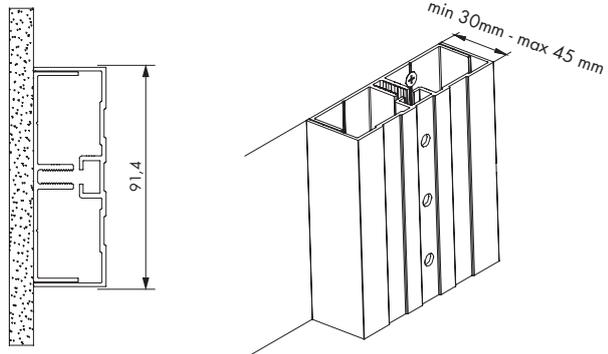
Entwickelt für DRIVE Doppelschiene (beinhaltet die Profile SAS 510.160 + SAS 510.161, Kunststoffprofil für Abdeckung der Bohrungen und Schrauben).
