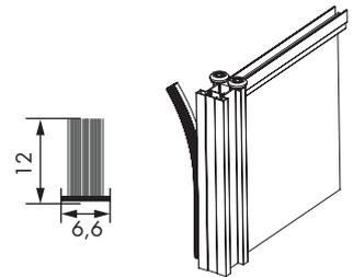
Bürste wird mit doppelseitigem Klebeband auf das Senkrechtprofil der Tür montiert.
