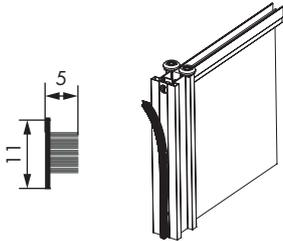
Bürste wird mit doppelseitigem Klebeband auf das Senkrechtprofil der Tür montiert. (Kann als Alternative zum Abdeckprofil verwendet werden).
