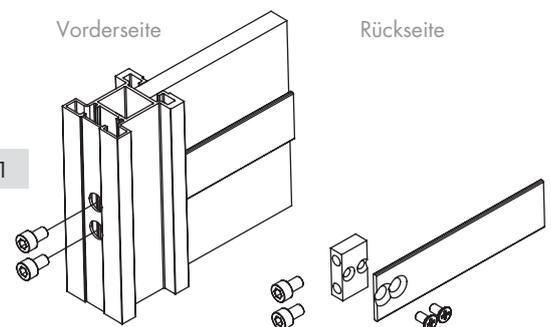
Wird für die Sicherung der Bürste oben und unten benutzt.
