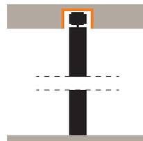
Optional: In die Decke eingebaute Schiene
