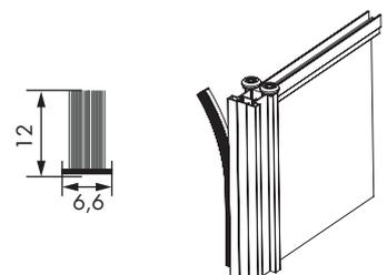
Bürste wird mit doppelseitigem Klebeband auf das Senkrechtprofil der Tür montiert. (Kann als Alternative zum Kunststoffprofil verwendet werden.)
