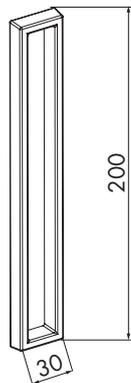
Griff wird mit doppelseitigem Klebeband montiert (mitgeliefert).
