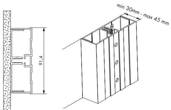
Entwickelt für DRIVE Doppelschiene (beinhaltet die Profile SAS 510.160 + SAS 510.161, Kunststoffprofil für Abdeckung der Bohrungen und Schrauben).
