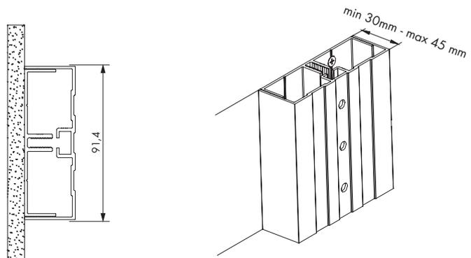
Entwickelt für DRIVE Doppelschiene (beinhaltet die Profile SAS 510.160 + SAS 510.161, Kunststoffprofil für Abdeckung der Bohrungen und Schrauben).
