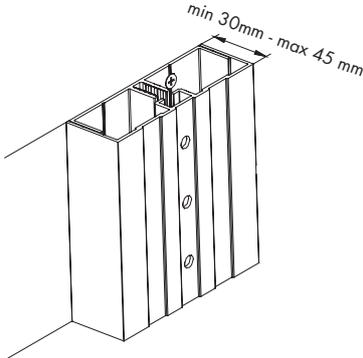
Entwickelt für DRIVE Doppelschiene (beinhaltet die Profile SAS 510.160 + SAS 510.161, Kunststoffprofil für Abdeckung der Bohrungen und Schrauben).
